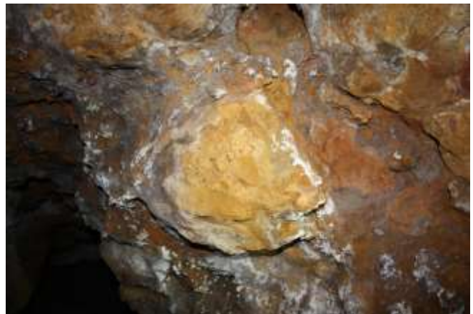
Foto 16 i 17 – Sostre de la mina amb limonita (goethita) en primer pla, també presència d'hematites (color roig fosc) i calcita (color blanc).
