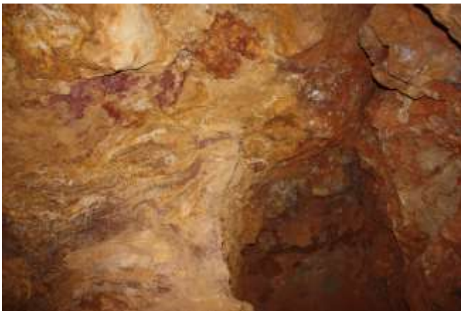
Foto 16 i 17 – Sostre de la mina amb limonita (goethita) en primer pla, també presència d'hematites (color roig fosc) i calcita (color blanc).
